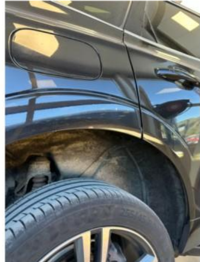
1.2 Steinsprut i skjerm høyre bak. Pusses og lakkeres forenklet
