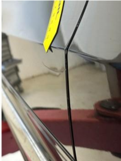
1.1 Bulk med lakkskade i dør venstre foran.
