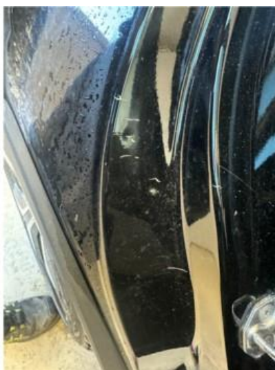
1.3 Noen riper i døråpning høyre bak
