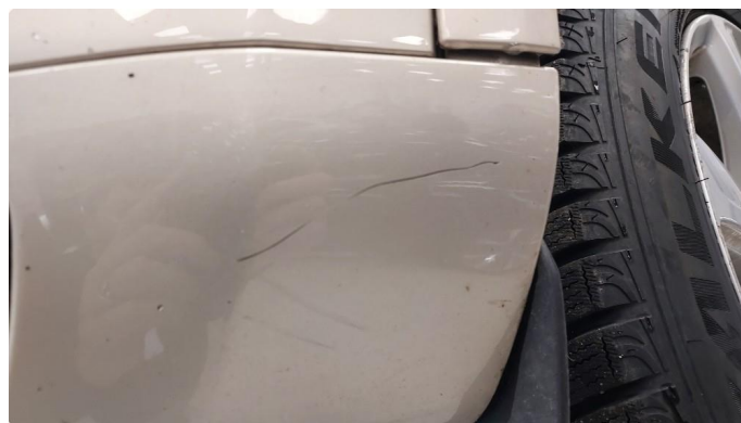
1.3 Litt oppripet på nedre del av fanger foran
