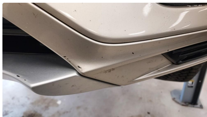
1.4 Noe steinsprut i fanger foran
