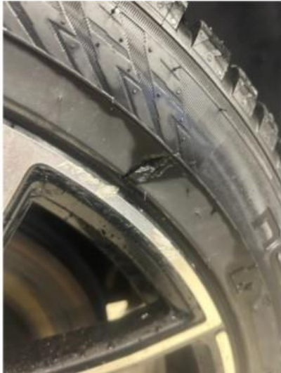
1.1 En vinterfelg litt kantkjørt. Skadet dekk blir byttet
