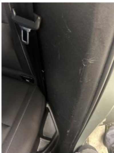
2.1 Noe oppripet/slitasje ved innsteg dør venstre bak
