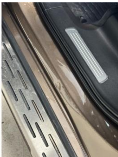
1.1 Bulk i døråpning venstre bak
