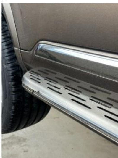
1.3 Liten "glippe" i stigtrinn begge sider bak
