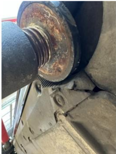
1.1 Liten sprekk i beskyttelsesplate under bil.
