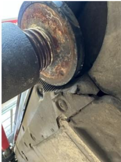
1.1 Liten sprekk i beskyttelsesplate under bil.
