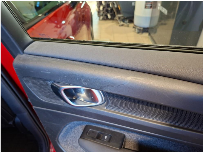
2.1 Noen riper i dørtrekk begge sider bak
