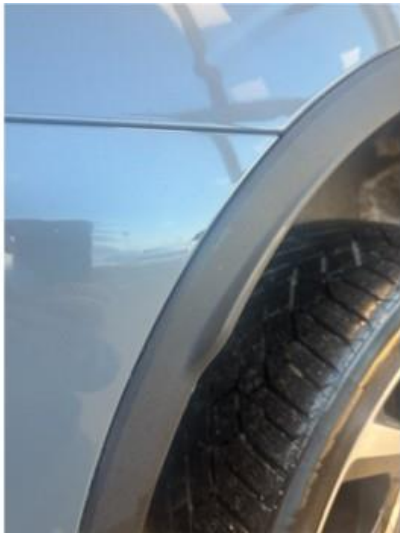
1.3 Liten lakkskade i fanger høyre bak. Lakkeres forenklet
