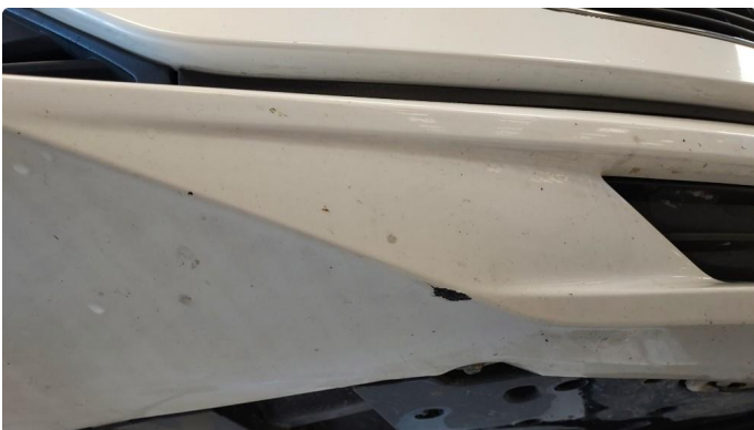
1.5 Litt oppripet på underside av fanger foran
