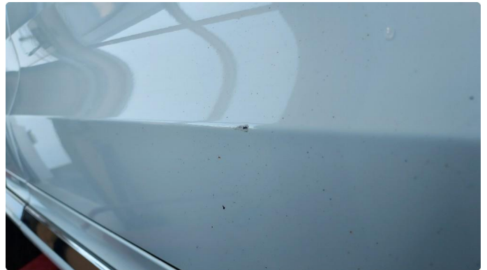
1.2 Liten lakkskade med bulk i profil på dør høyre foran
