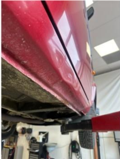
1.1 Liten skade på kanal
