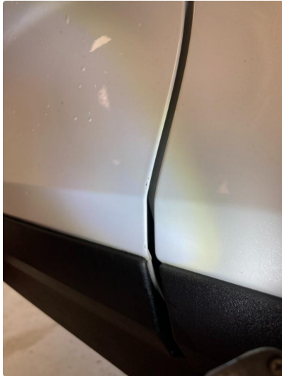
1.1 Ripe ned til grunning på dør venstre foran. Lakkeres forenklet
