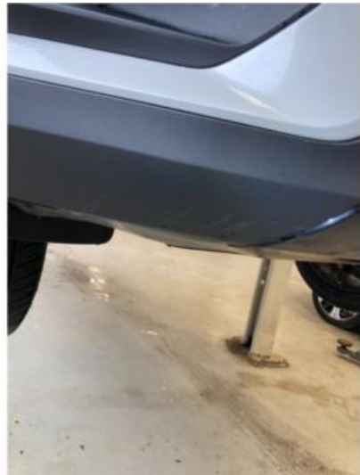
1.3 Litt oppripet på underside av fanger foran
