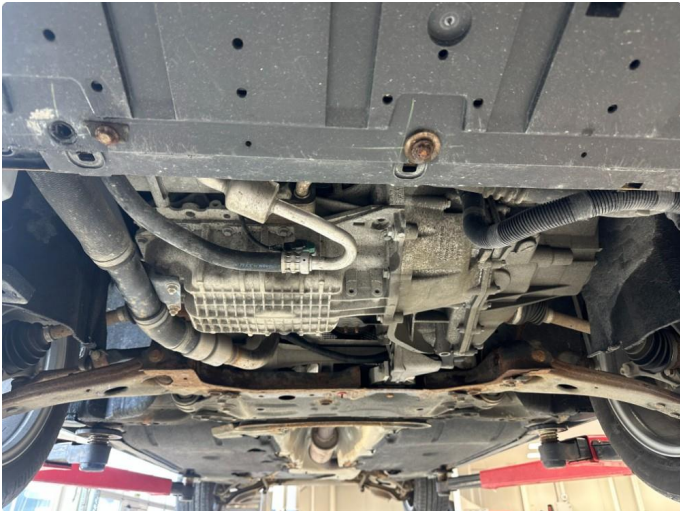
1.1 Noen sprekker i beskyttelsesplate under bil
