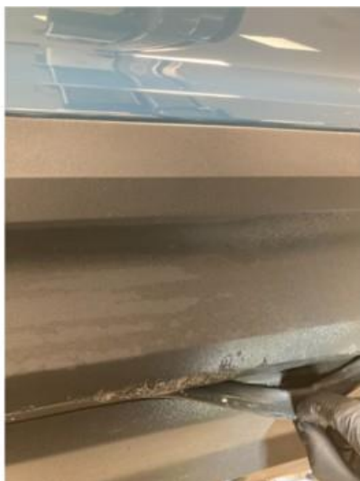
1.1 Liten skade i plastdeksel på nedre del dør venstre foran
