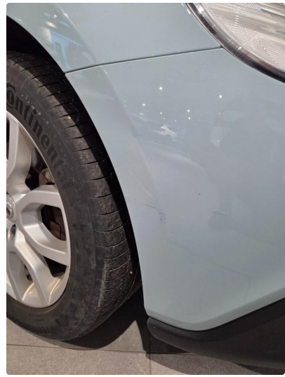
1.4 Noen lakkskader i fanger høyre foran. Lakkert forenklet
