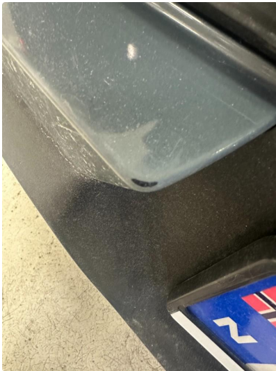
1.2 2 små hakk i fanger bak
