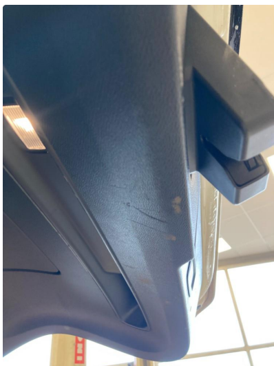
2.1 Litt oppripet i panel på innside av bakluke
