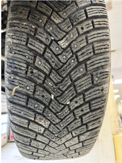
1.1 Vinterhjul mangler noen pigger.
