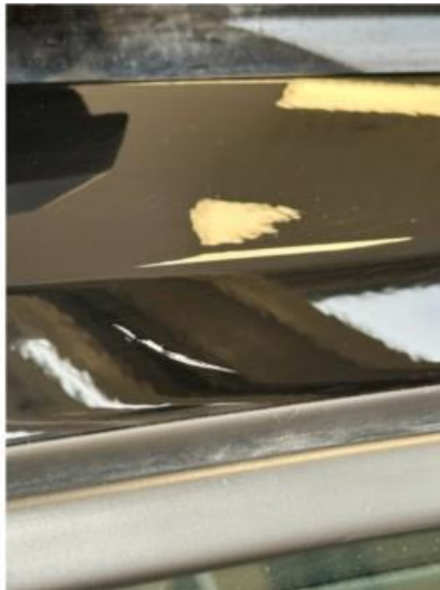
1.2 Noen små riper på tak høyre side. Dempes med rubbing og polering
