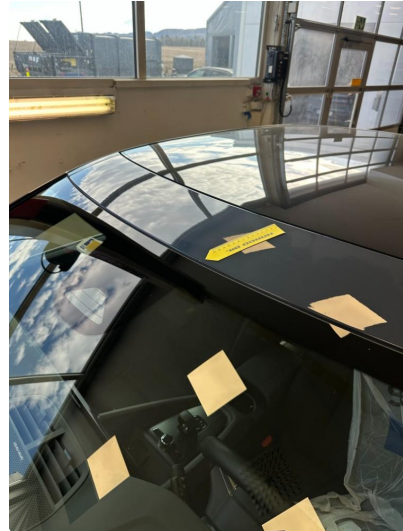
1.1 Liten steinsprut i forkant tak
