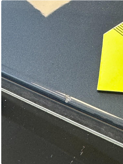
1.1 Liten steinsprut i forkant tak
