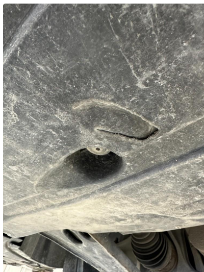
1.2 Liten sprekk i beskyttelsesplate under bil
