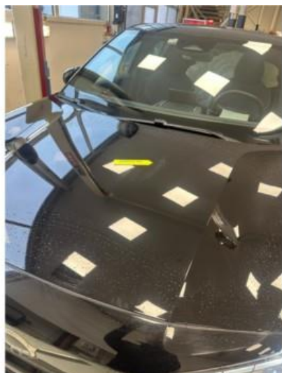
1.1 Noen riper i panser. Dempes med rubbing og polering.
