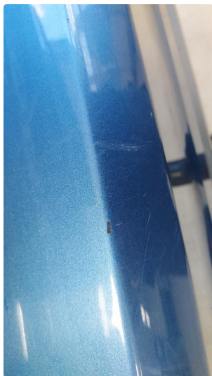
1.3 Ett par små sår i lakk lastesone fanger bak
