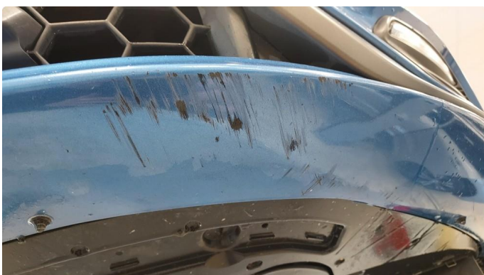
1.2 Noe oppripet på underside av ganger foran
