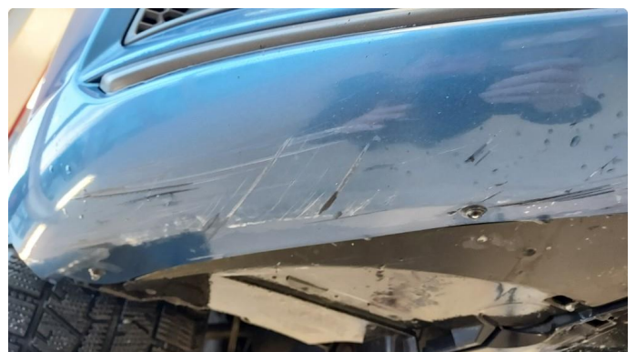
1.2 Noe oppripet på underside av ganger foran
