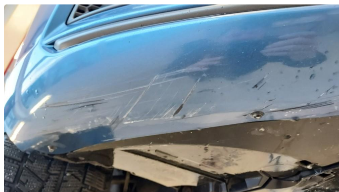
1.2 Noe oppripet på underside av ganger foran
