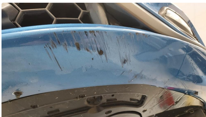
1.2 Noe oppripet på underside av ganger foran
