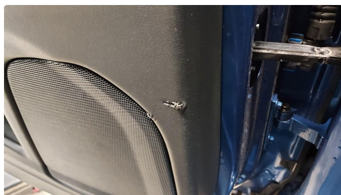
2.1 Hakk i dørtrekk venstre bak
