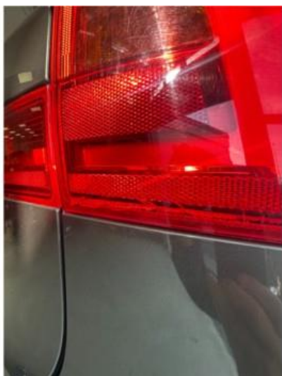
2.1 Noe krakelering plast i lys høyre bak. EU godkjent
