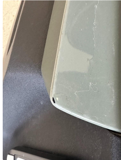
1.1 Ett par små hakk i lastesone fanger bak
