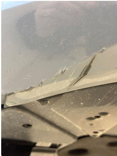
1.2 Litt oppripet på underside av fanger foran
