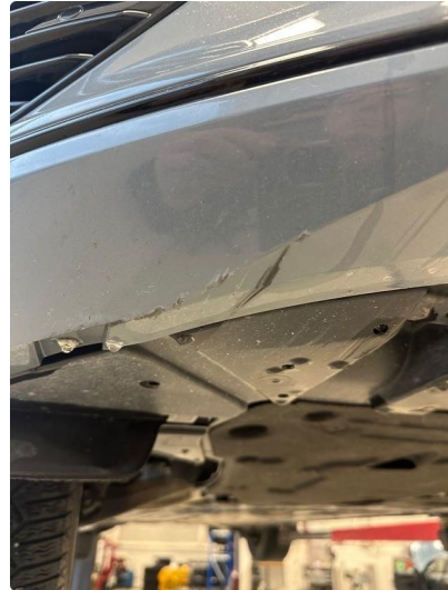
1.2 Litt oppripet på underside av fanger foran
