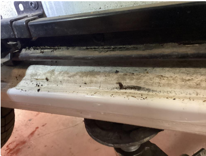
1.2 Noe slitasje/påbegynt korrodering
