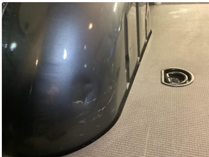
2.1 Bulker i hjulbuene innvendig i varerom. Også bruksmerker ellers i varerom.
