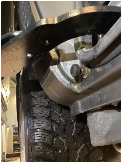
1.2 Påbegynt korrosjon - normalt etter alder.
