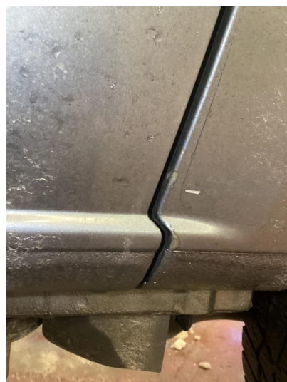
1.3 Påbegynt korrosjon. Normalt etter alder.
