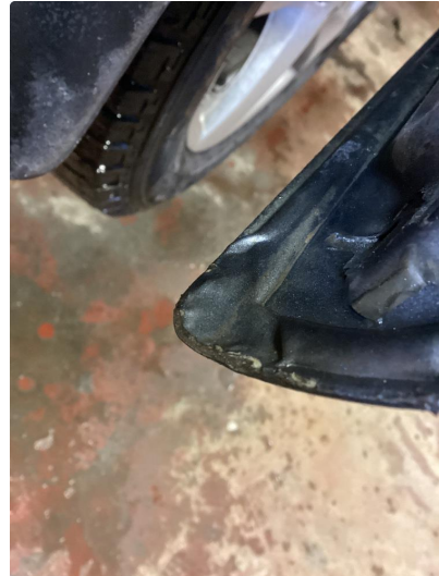
1.2 Påbegynt korrosjon - normalt etter alder.
