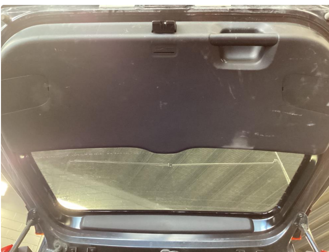
2.2 Slitasjemerker innvendig på bakluke
