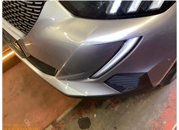
1.4 Litt steinsprut i front
