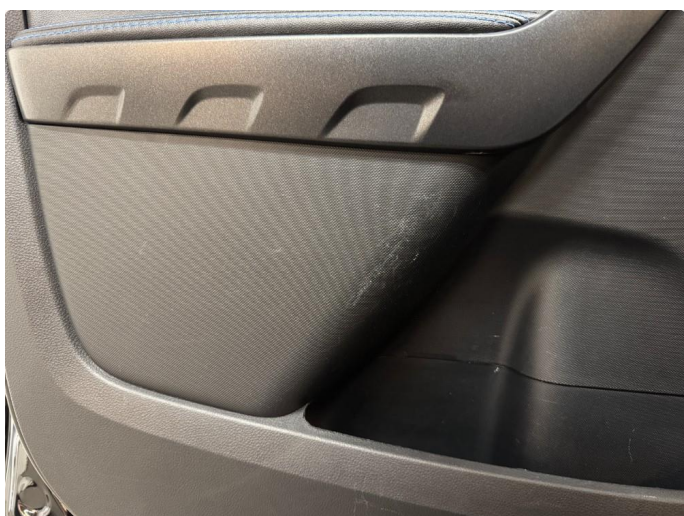
2.1 Hakk / Merker på dørtrekk
