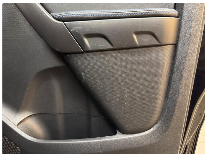
2.1 Hakk / Merker på dørtrekk
