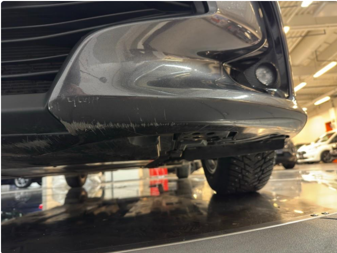
1.1 Skraper underkant + liten sprekk nede
