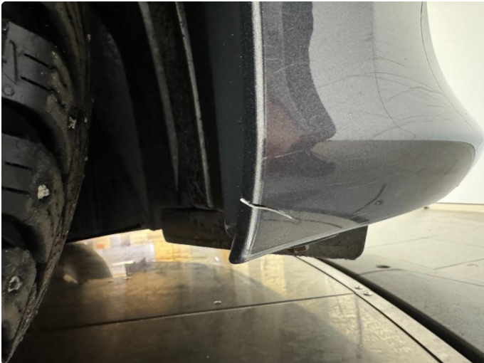
1.1 Skraper underkant + liten sprekk nede
