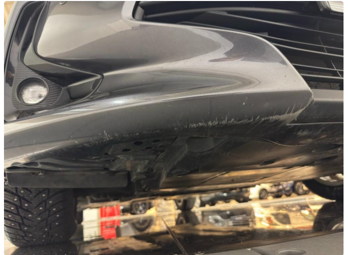
1.1 Skraper underkant + liten sprekk nede
