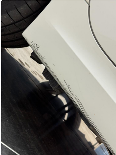
1.1 Skrape på kanalskjørt
