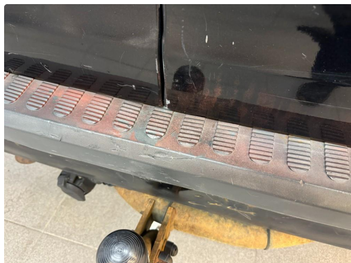
1.1 Amatørmessig utført arbeid. Tidligere eier lakkert selv. Rust.
