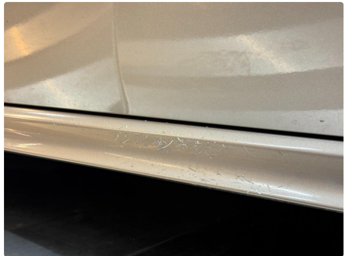
1.2 Slitasje / bruksmerker kanal v/innsteg
