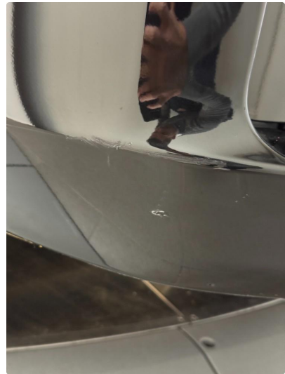
1.1 Diverse små lakkskader i plast
