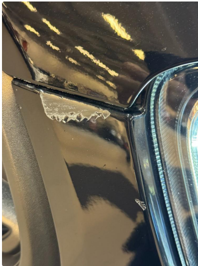
1.1 Diverse små lakkskader i plast
