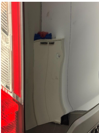
1.1 Diverse små lakkskader i plast
