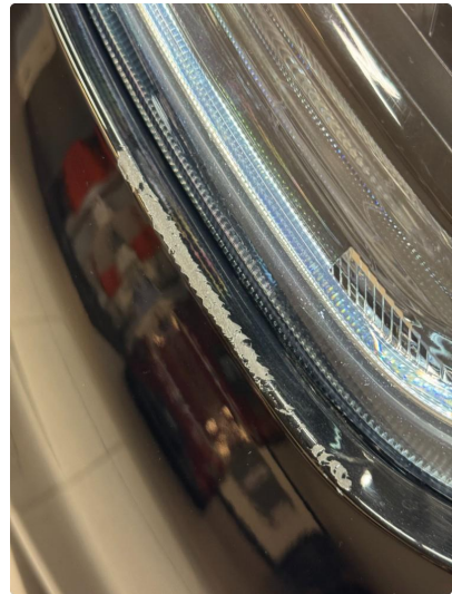
1.1 Diverse små lakkskader i plast
