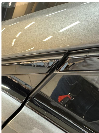
1.3 Irr / Korrosjon i trekant-list
