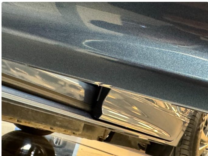
1.1 Lite hakk / sår i plast underkant
