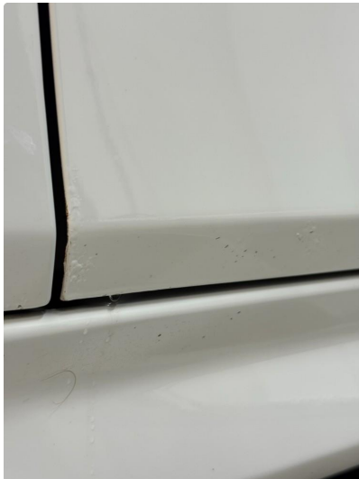
1.1 Steinsprang med rust
