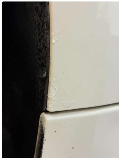
1.2 Steinsprang med rust
