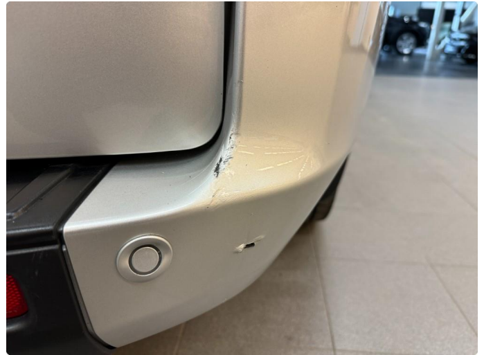
1.2 Hakk/Sår i plast
