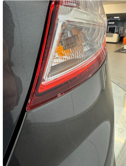
1.1 Krakylerte lamper, ingen fukt
