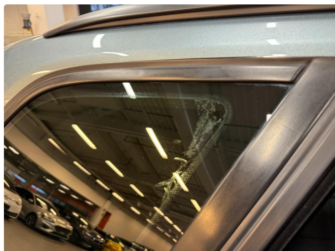
1.3 Solfilm amatørmessig utført arbeid
