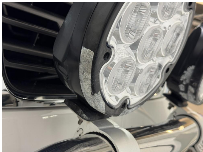
2.1 Korrosjon på ekstralys
