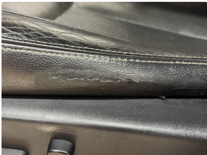
3.1 Slitasje på førerstol, reparert
