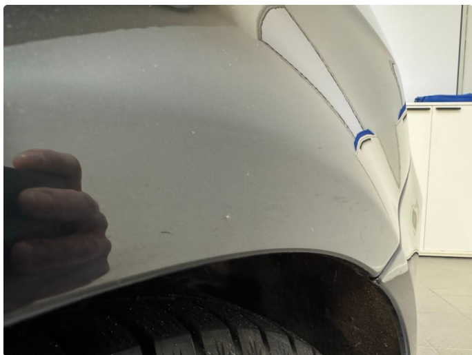
1.6 Steinsprang med rust
