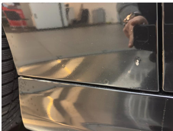
1.5 Steinsprang med rust
