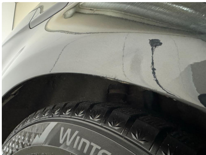
1.6 Steinsprang med rust
