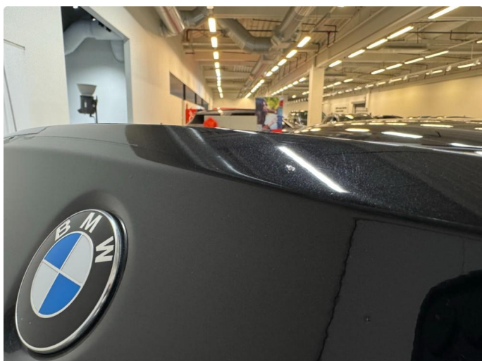
1.4 Zinkslipp / Steinsprang med rust
