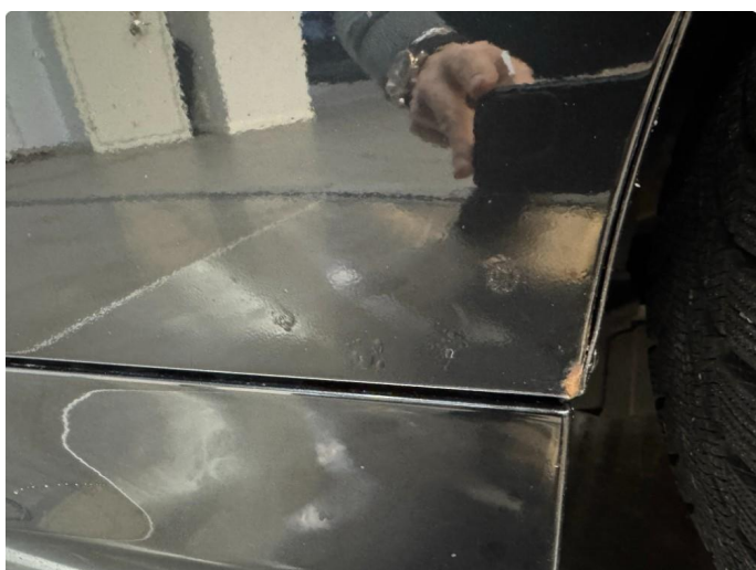
1.5 Steinsprang med rust
