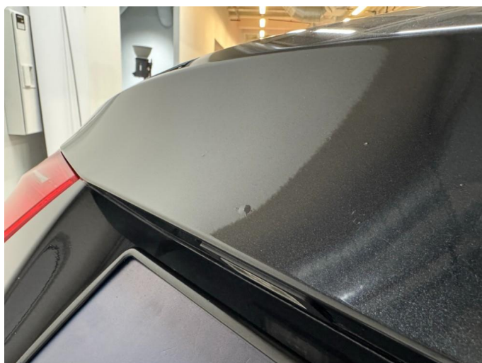
1.4 Zinkslipp / Steinsprang med rust
