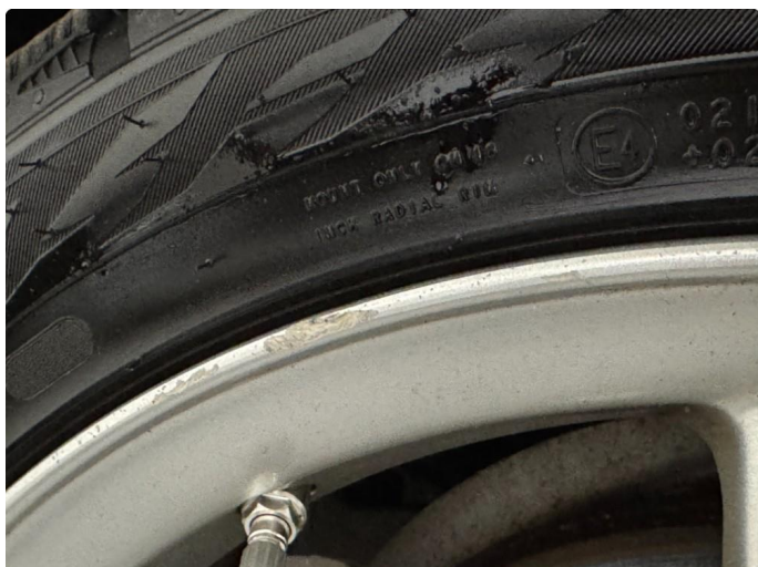
1.1 Noe kantkjørt / korrosjon
