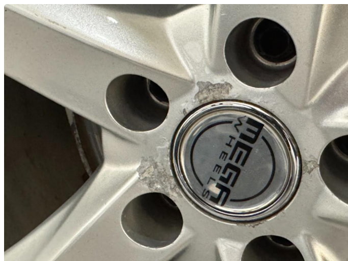
1.1 Noe kantkjørt / korrosjon
