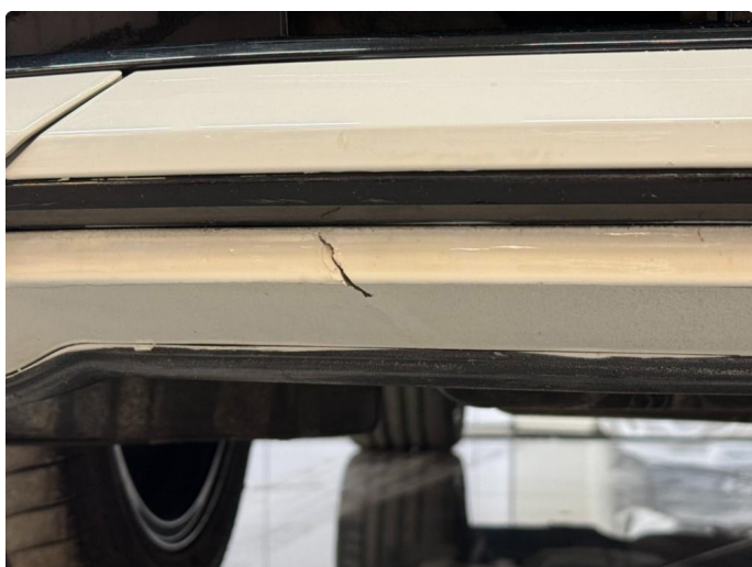
1.4 Sprekk i støtfanger foran
