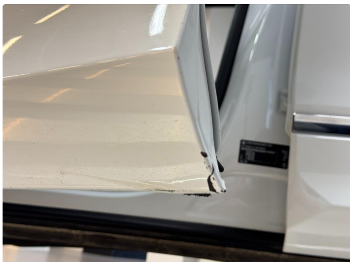
1.1 Sprekk i plast
