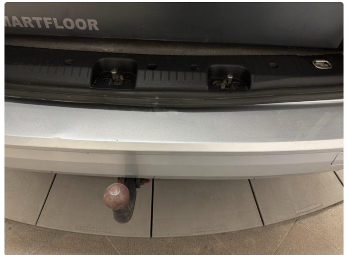
1.1 Bruksslitasje varerom + innlastningsone
