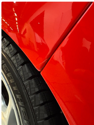
1.1 Lakslipp med rust
