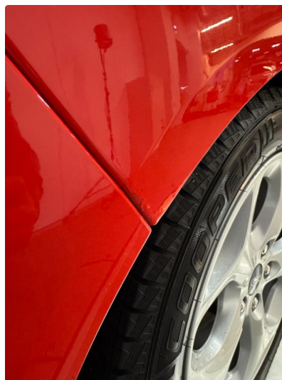
1.1 Lakslipp med rust
