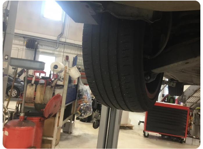
1.1 Skjev slitasje på sommerdekk
