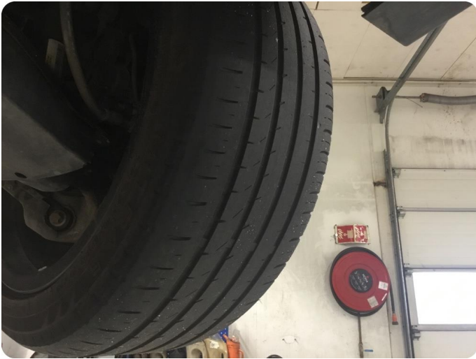
1.1 Skjev slitasje på sommerdekk
